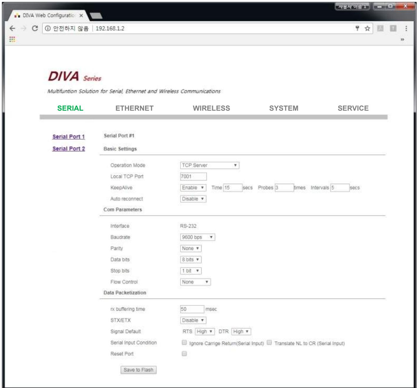
**SERIAL** 페이지는 RS232 포트와 RS422/485 포트에 대한 동작 모드와 TCP/IP 연결에 사용되는 소켓 파라미터, 시리얼 통신 파라미터, 시리얼 데이터를 TCP/IP 패킷으로 변환할 때 적용되는 항목들을 설정합니다. 좌측에 표시되는 [Serial Port 1](#) 링크를 클릭하면 RS232 포트(DB9 Male 커넥터)를 설정할 수 있고 [Serial Port 2](#) 링크를 클릭하면 RS422/485 포트(5핀 터미널블록 커넥터)를 설정합니다. RS232 포트와 RS422/485 포트는 각각 독립적으로 동작하며 이더넷 네트워크를 통해 동시에 데이터를 송수신할 수 있습니다.
