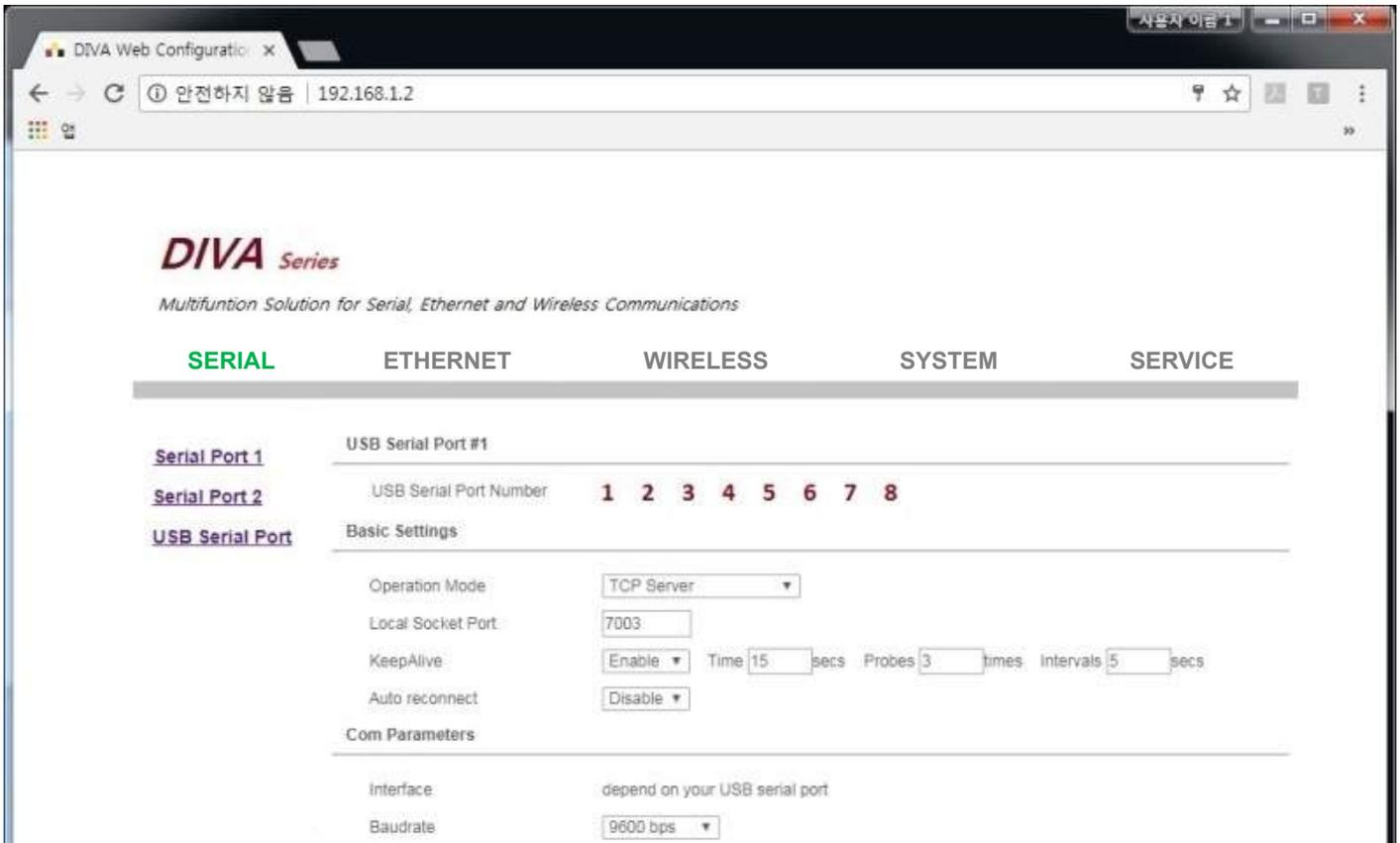
**USB Serial Port** USB Serial 컨버터가 인식될 경우 좌측 메뉴에 표시됩니다.
