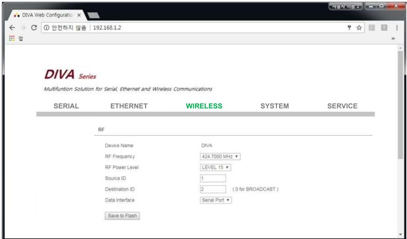
**RF Frequency** 424MHz 및 447 MHz 대역에서 사용할 무선 채널을 선택합니다. 무선을 통해 데이터를 송수신하는 모든 DIVA-IRM 장치는 동일한 채널로 설정되어야 합니다. 서로 다른 채널로 설정된 DIVA-IRM 장치 사이에는 무선 통신을 연결할 수 없습니다. 또한 인접한 채널과의 간섭이 발생하지 않도록 5채널 이상 떨어진 채널을 사용하시기 바랍니다. 가령 인접한 RF 시스템에서 424.8000MHz 채널을 사용하고 있을 경우 신규로 추가되는 RF 시스템은 424.7375MHz 이전 채널이나 424.8625MHz 이후 채널을 사용해야 합니다.
