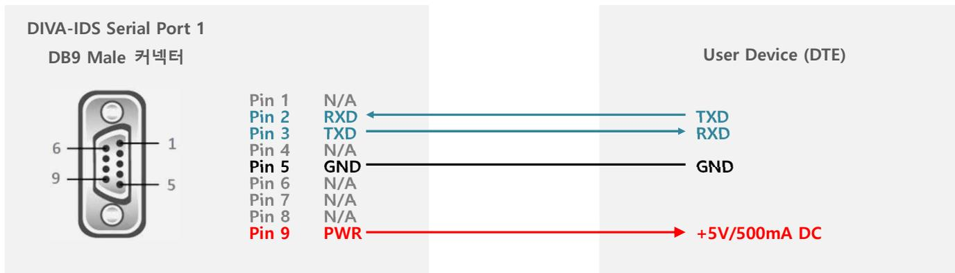
※ 사용자 요청에 따라 RS232 포트의 9번 핀을 통해 5VDC/500mA 전원을 출력하는 모델을 주문 제작하여 공급해 드립니다.
