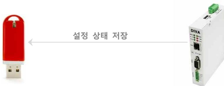
**RESTORE** 버튼을 클릭하면 USB 메모리에 저장된 설정 파일을 DIVA-IDS 장치로 업로드하여 설정 상태를 복구합니다. USB 메모리에는 1개의 설정 파일만 저장되어 있어야 합니다.
